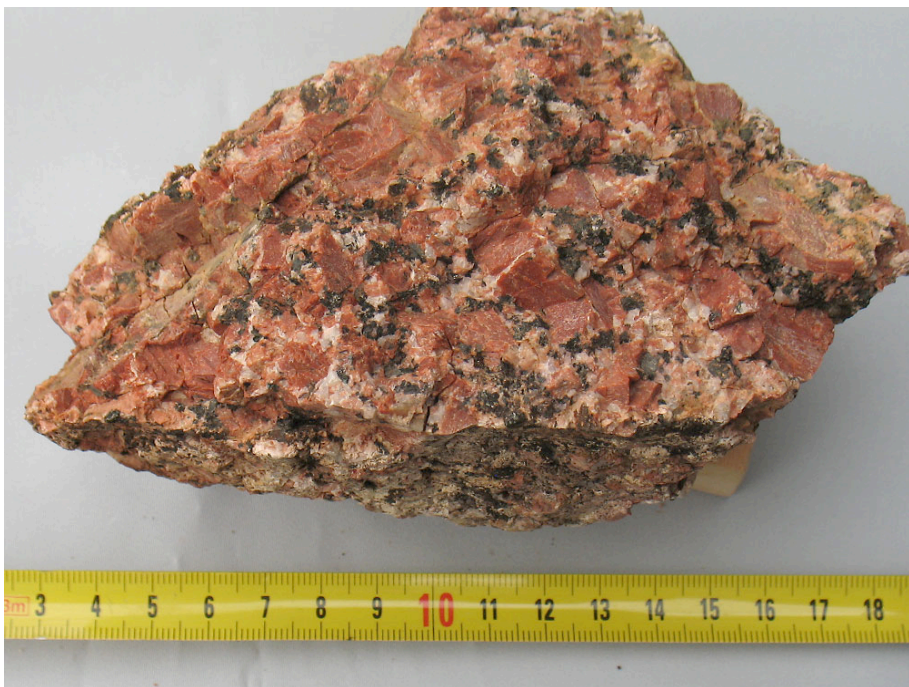
Fig. 5: De vita kristallerna är plagioklas, ingen kvarts (IMG_2792)
