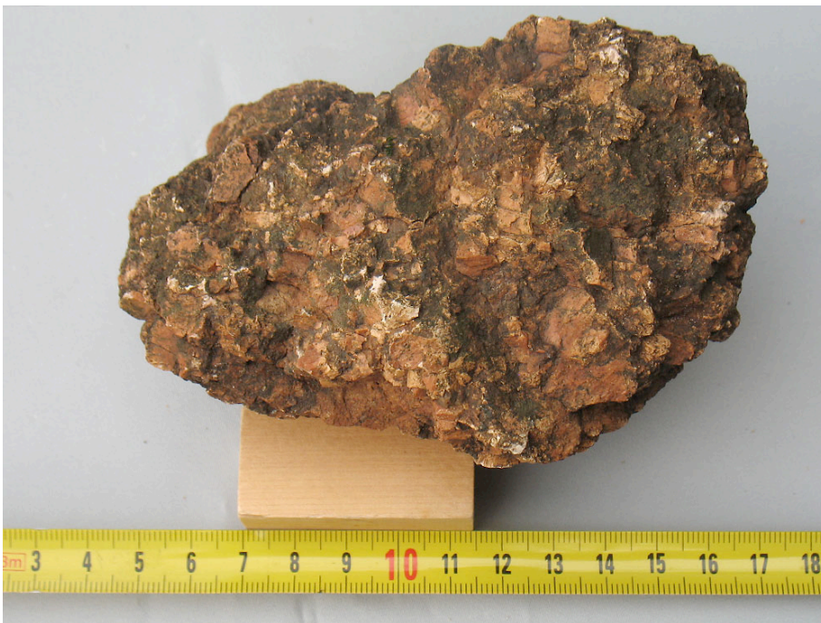
Fig. 7: De flesta kristallkorn är mikroclin (IMG_2799)
