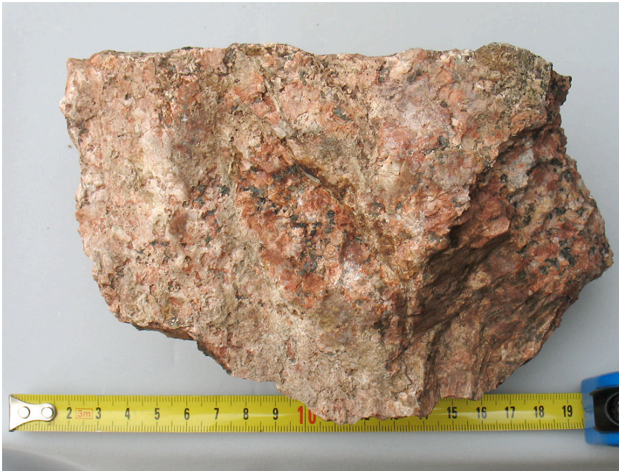
Fig. 6: Den grå hinnan vänster och nertill är en tunn hinna av smälta (IMG_2797)
